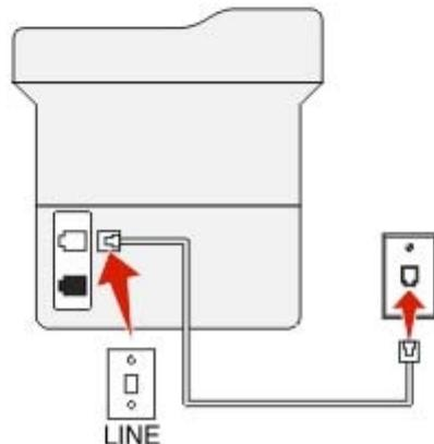
**1** 将电话线的一端连接到打印机的线路端口。
