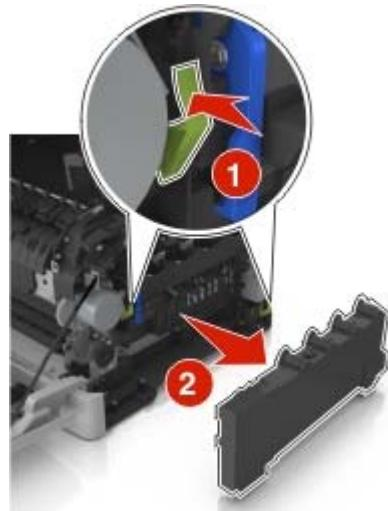
6 抬起成像组件上的蓝色控制杆，然后拉成像组件，直到停止。
