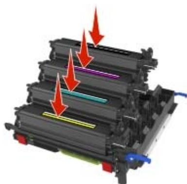
**注意:** 确认每个显影部件都被插入相匹配的颜色插槽中。
