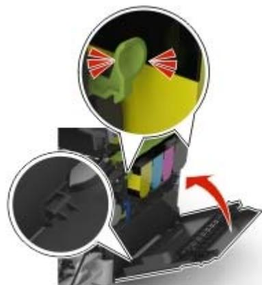
9 滑动并按住打印机右边的释放插销，然后缓慢地关闭顶部盖门。
