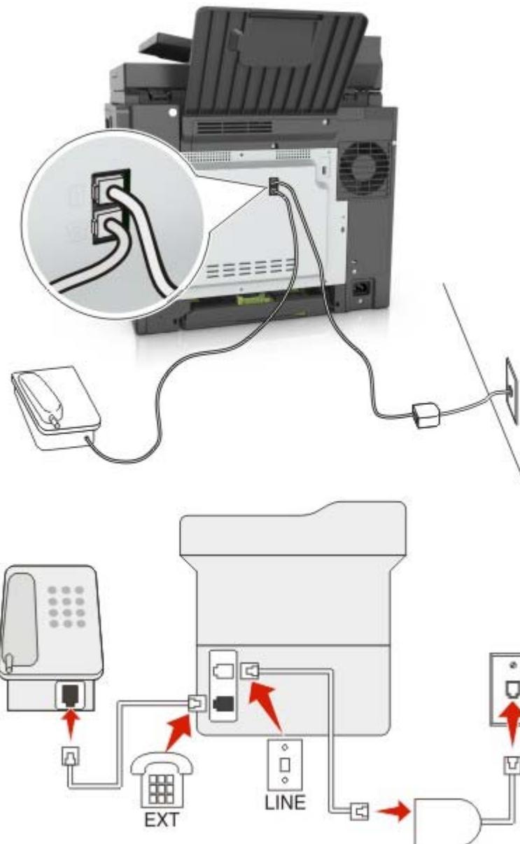
数字用户线 (DSL) 将您的常规电话线路分为两个通道：语音和 Internet。电话和传真信号通过语音通道传输，而 Internet 信号通过另一个通道传输。
