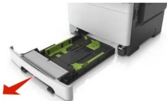
**2** 如果纸张长度大于 letter 尺寸的纸张, 请压住, 然后滑动进纸匣后部的长度导片来延伸它。
